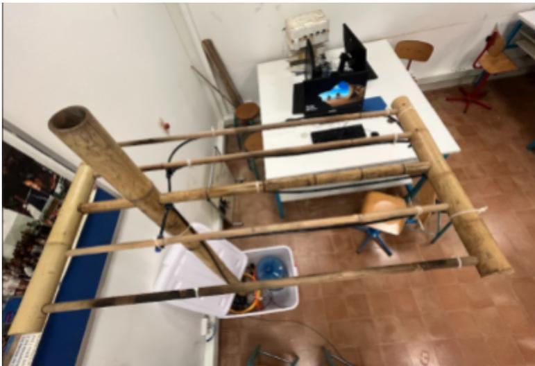
**Après le perçage des tiges et des poutres de bambou, et l'assemblage des pièces, voici le premier prototype avec une hauteur de 2m**
